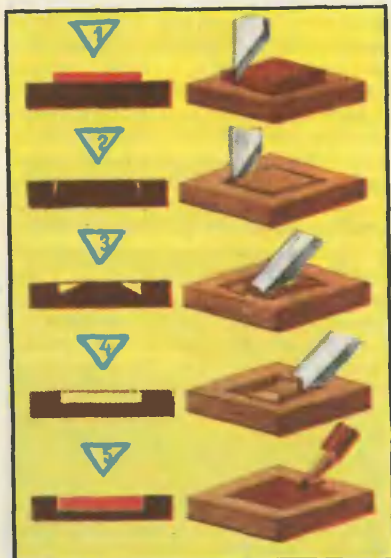
Последовательность врезания вставки.
